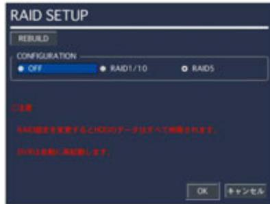
RAIDを構成するにはRAID1/10/5にチェックを入れ、OKボタンを選択します。再起動後、レイドが構築され、HDDのフォーマット画面に切り替わります。フォーマット後、RAID構成で起動します。
